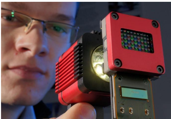
Array-Projektoren sind sehr klein und liefern trotzdem sehr helle Bilder (Quelle: Fraunhofer IOF).
