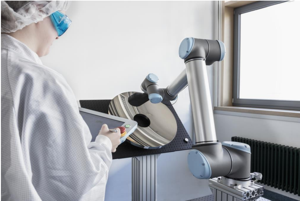
Bild 2) Roboterassistierte Streulichtmessung. (©Fraunhofer IOF)
