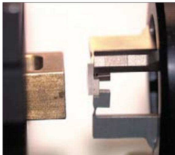
Abb. 1: Dreibackengreifer mit freier optischer Apertur für miniaturisierten Laserresonatorspiegel.
