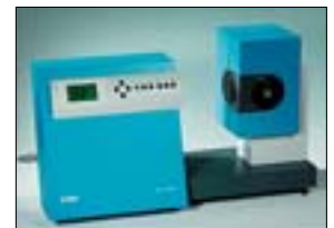
Fig. 4: Hazemeter „haze-gard dual“, /5/.
