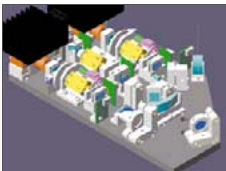
Abb. 5: Mechanische Konstruktion der kompletten RGB-Quelle.
