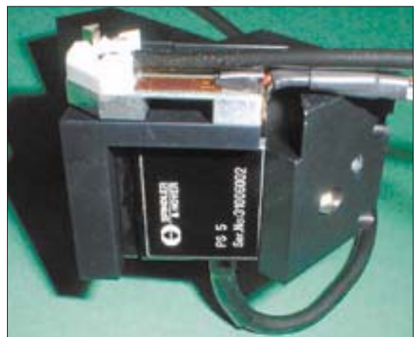
Abb. 2: Vakuumgreifer für Prisma, einschließlich Kraftsensorik und Positioniersystem.
