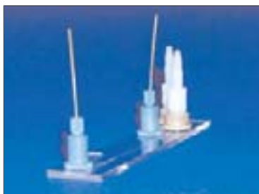
Abb. 4: Mikrofluidisches System mit kommerziellen Fittings für die Ankopplung von Gasen und Flüssigkeiten, Quelle: microfluidic ChipShop.
