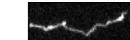
Abb. 6: 2-D-Mikroelektrophorese in den Chips aus Abb. 5 auf einem kationischen Nanofilm mit fluoreszenzgelabelter Lambda-DNA, Quelle: Valentin Kahl, ibidi.
