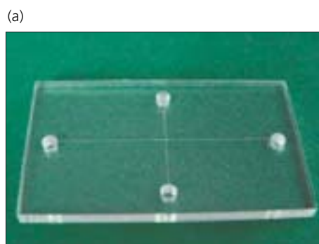
Abb. 5 a, b: Kapillarelektrophorese-Chip aus Topas (a) und elektronenmikroskopische Aufnahme des Kreuzungspunktes (b), Design: ibidi.
