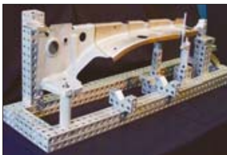
Abb. 5: Bild und 3-D-CAD-Vergleich einer PKW-Karosseriebaugruppe.
