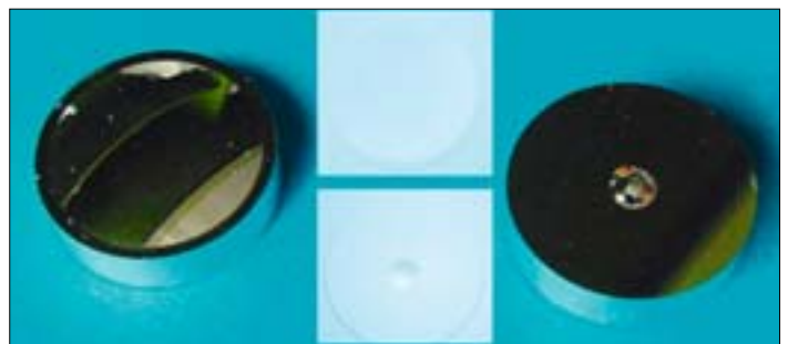
Abb. 5: Hohlspiegel in LTCC: Prägewerkzeuge mit optisch glatten Oberflächen und gesinterte Abformungen.
