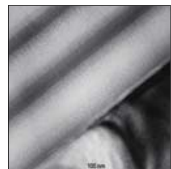
Abb. 3: TEM-Querschnittsaufnahme der ersten zwei Perioden eines Rugatefilters. Aufnahme von Ute Kaiser, FSU Jena.
