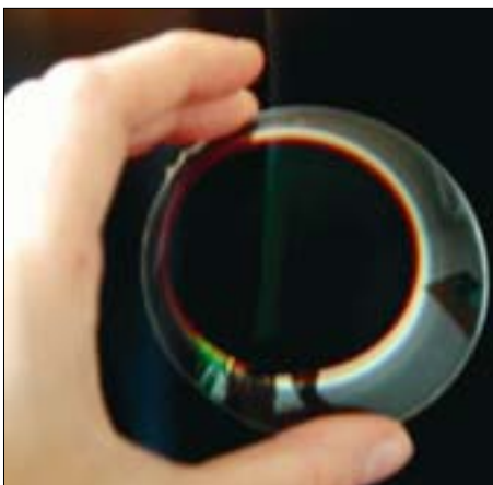
Abb. 5: AR-hard®-Breitbandbeschichtung auf einer Teilfläche eines CR39-Brillenglases.
