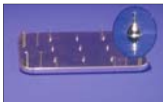
Abb. 4: Trägerplatte mit neun hochgenau bearbeiteten Prägekörpern. Mit dieser Vorrichtung werden bis zu 15 Lagen LTCC-Grünfolie gestapelt und nachfolgend unter hohem Druck zu einem homogenen Substratkörper laminiert. Gleichzeitig erfolgt das Einprägen der Reflektorstruktur.
