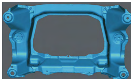
Abb. 4: Aus der Punktwolke generiertes STL-Modell der Oberfläche.
