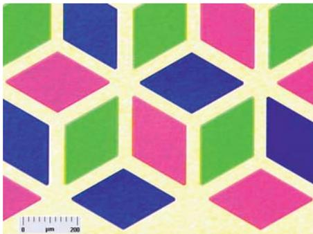
Abb. 5: Lithographisch strukturierte absorptive Farbfilterstrukturen auf Glaswafer.
