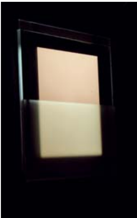
Abb. 3: Weiße OLED (Merck KGaA, Mainz), die in der unteren Hälfte mit einem Mikrolinsenarray (IOF) versehen ist. Ohne die Mikrostruktur ist in der oberen Hälfte der Stirnfläche deutlich die Substratstrahlung zu erkennen.
