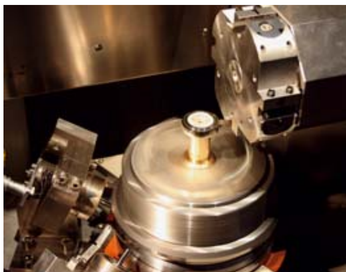
Abb. 3: Justierdrehen einer gefassten Linse.
