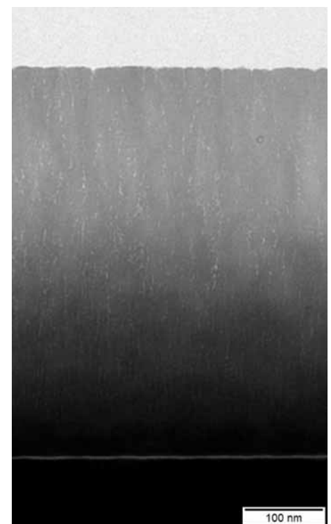
Abb. 2: TEM-Querschnittsaufnahme der in Abb. 1 rechts markierten Tantalpentoxidprobe. Die Porenfraktion ist gut erkennbar, trotzdem ist die Probe shiftfrei.
