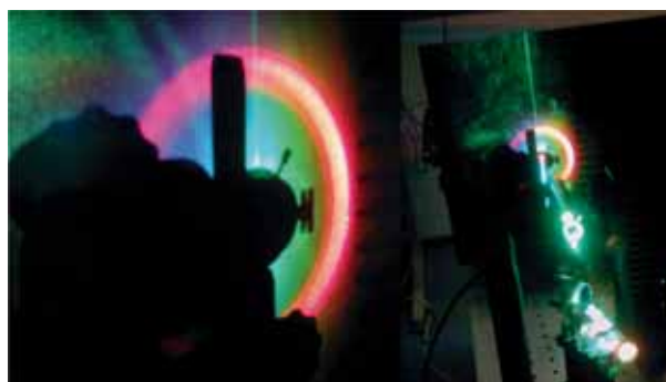
Abb. 4: Superfluoreszenz in einer OPA-Stufe ohne Signal.
