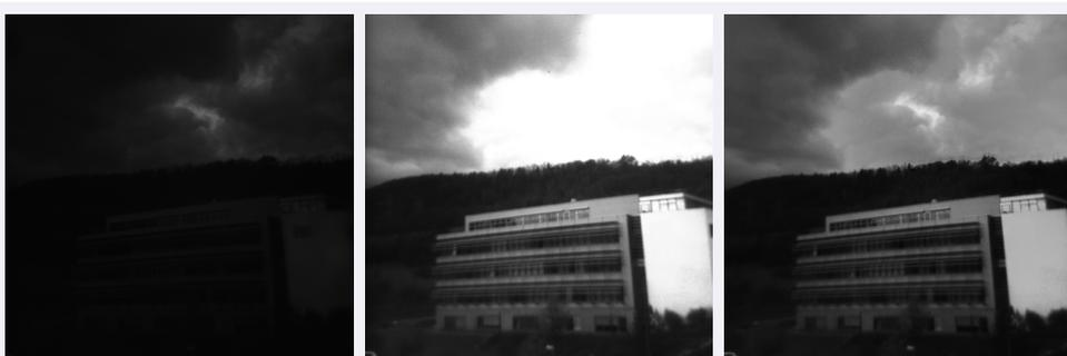
**2** Zeitgleich aufgenommenes Bild des lichtunempfindlichen (links) und lichtempfindlichen optischen Kanals (mittig) sowie die HDR-Kombination aus beiden (rechts). |
