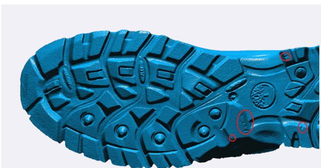
2 Scan-Ergebnis einer Schuhsohle mit relevanten Details zur Identifizierung von Tätern. | Scan result of a shoe sole with marked details relevant for identification of criminals.
