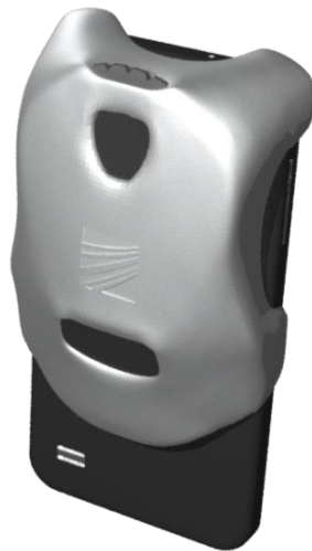
Abbildung1 : Entwurf eines 3D-Messaufsatzes für Mobiltelefone von Peter Lutzke ( © Fraunhofer IOF)
