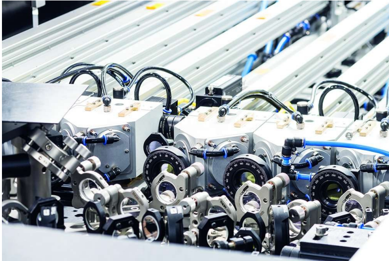
Abb. 3: Die Skalierung der Multi-kW-UKP-Faserlaser aus Jena beruht auf der kohärenten Kombination mehrerer Einzelstrahlen. (© Fraunhofer IOF/IAP)
