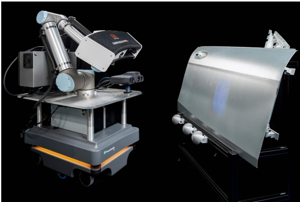
Fig. 1: »3D-Kosyma« vermisst eine Autotür. Dort findet das System einen Schaden und markiert den Bereich mit einem Lichtsignal.
