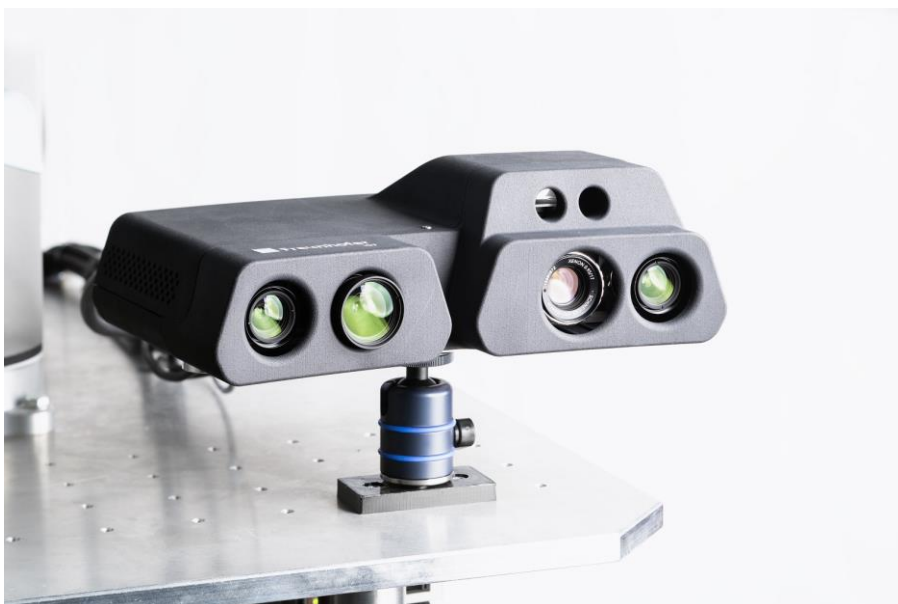
Fig. 3: Ein 3D-Sensor überblickt die Szene und registriert sowohl die Gestik eines Menschen als auch die präsentierten Bauteile.
