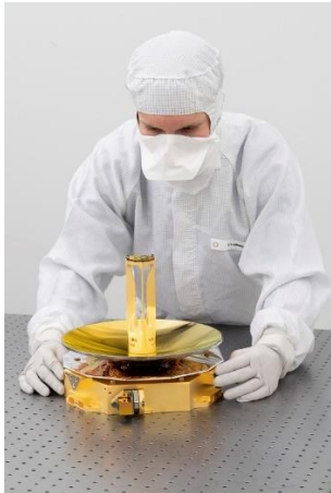
Abb. 2 und 3: Für das Messinstrument GALA wurde am Fraunhofer IOF in Jena ein Spiegelteleskop entwickelt. © Fraunhofer IOF
