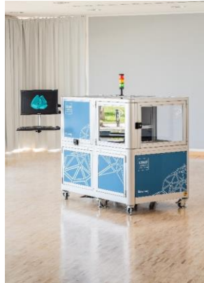
Abb. 3 / Abb. 4: »Glass360Dgree«: Erstes MWIR-3D-System für die Überprüfung von Glaskörpern in der Optikfertigung (Copyright: Fraunhofer IOF)
