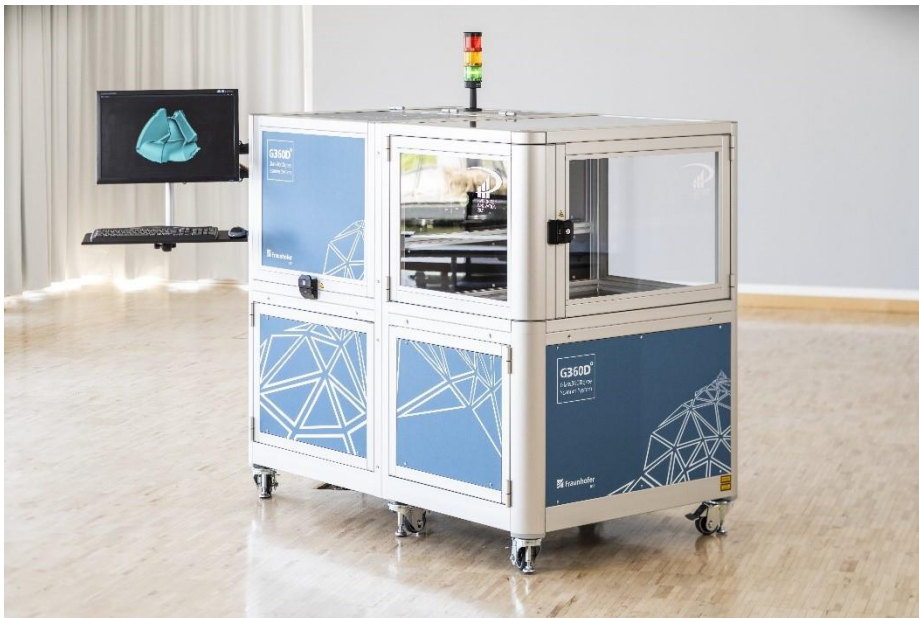
Abb. 2: »Glass360Dgree«: Erstes MWIR-3D-System für die Überprüfung von Glaskörpern in der Optikfertigung (Copyright: Fraunhofer IOF)
