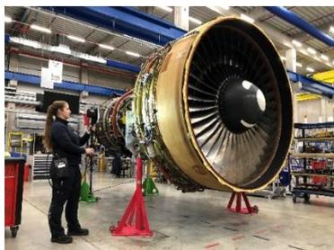
Abb. 3: Eine MTU-Mitarbeiterin digitalisiert ein Triebwerk. © MTU Maintenance
