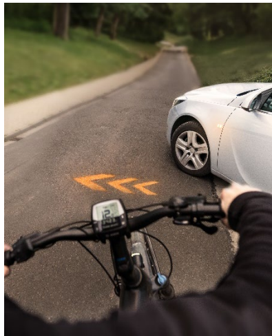
Abb. 1: Das Blinksignal wird in einer dynamischen Bewegung auf die Fahrbahn projiziert und zeigt den Richtungswechsel des Autos an. Dank der hohen Lichtintensität ist das Signal auch bei Tageslicht gut sichtbar. © Fraunhofer IOF
