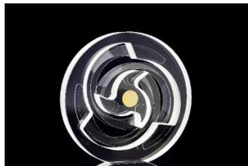
Der monolithische Glasresonator mit hauchdünnen Blattfedern wird durch ein spezielles Fügeverfahren hergestellt. © Fraunhofer IOF
