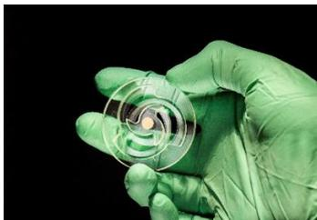
Forschende aus Jena haben für die Schwingungssensoren des Einstein-Teleskop hochempfindliche Resonatoren erstmals komplett aus Glas hergestellt. © Fraunhofer IOF
