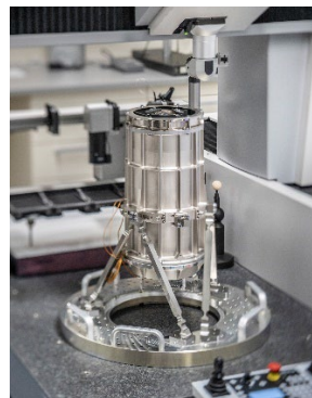
Das Metallspiegel-Teleskop zur Demonstration des Spektrometer-on-Chip-Konzeptes zur spektralen Erdbeobachtung © Fraunhofer IOF
