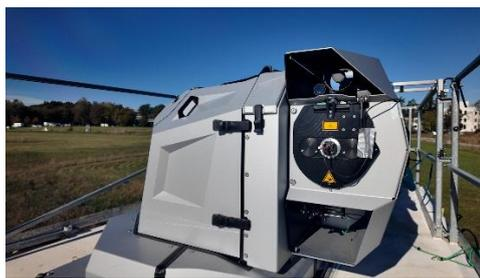
Auf dem Dach des QuBUS befindet sich das Empfangsteleskop für den Quantenkanal. © DLR
