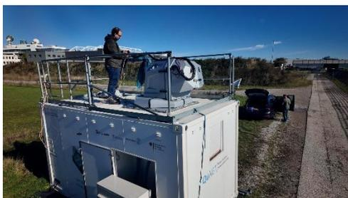
Der QuBUS, ein mobiler Container, ist die optische Bodenstation zum Empfang der Signale. © DLR
