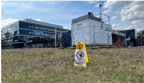
Der QuBUS (weißer Container rechts vorn) empfängt als optische Bodenstation die vom Flugzeug gesendeten Signale und leitet sie an das benachbarte MPL (Gebäude im Hintergrund) weiter.
