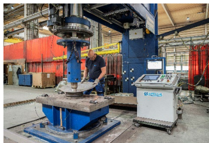
Ein Werker bei der Formung eines Probestücks. Dank des Messsystems kann bei der Umformung auf den Einsatz von Prüfschablonen verzichtet werden. © Fraunhofer IOF
