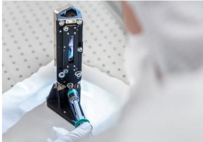
Abb. 1: Der Doppelspalt des Fraunhofer IOF wurde aus Silizium gefertigt. © Fraunhofer IOF
