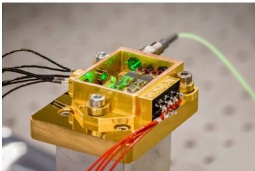
Abb. 1 Das in Jena aufgebaute Lasermodul vereint kleine Baugröße mit größter Robustheit. Nun fliegt es zum Marsmond Phobos. © Fraunhofer IOF
