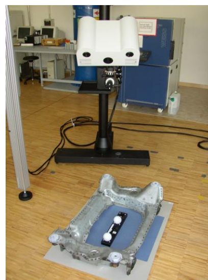
Abb. 7: Grundanordnung eines mobilen Stativmesssystems.
