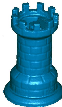
Abb. 27: Rapid-Prototyping Teil „Turm“: Foto und Messergebnis (STL-Darstellung).
