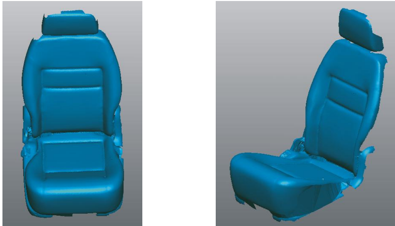
Abb. 21: Vermessung eines PKW-Sitzes.
