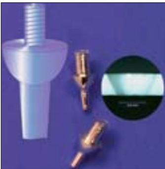
Abb 3: Prägekörper für LED-Gruben: Schema, realisierte Muster und Schnitt eines geprägten Reflektors.
