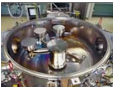
Abb. 3: Vakuumkammer mit Substratstationen.
