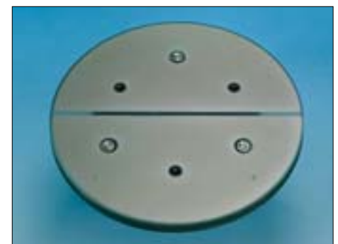
Abb. 3: Chuck-Oberfläche mit bipolarer Elektroden-Konfiguration.
