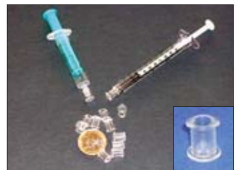
Abb. 5: Luer- und Luer Lok-kompatible Anschlüsse für eine einfache Montage auf Lab-on-a-Chip-Systemen.
