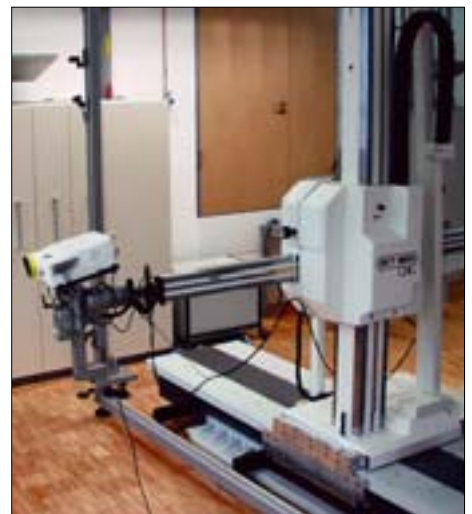
Abb. 4: Flexibles phasogrammetrisches Messsystem in Portalbauweise – „kolibri – portal“.
