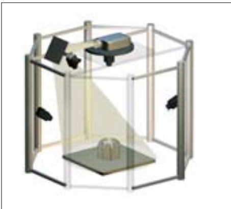
Abb. 3: Flexibles phasogrammetrisches 3-D-Messsystem „kolibri II“.
