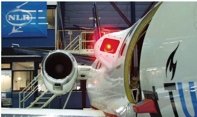
Abb. 5: Scanner nach dem Einbau in das Forschungsflugzeug des Niederländischen Nationalen Laboratoriums für Luft- und Raumfahrt (NLR). Der sichtbare Laserstrahl gehört zu einem Justierlaser.
