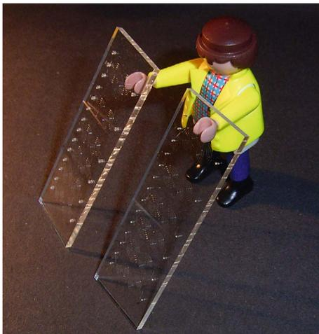
Abb. 1: Mikrofluidikchips im Standardformat.
