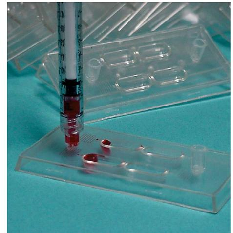
Abb. 3: Mikrofluidik-Plattform als »simpler Plastikchip« für die Diagnostik.
