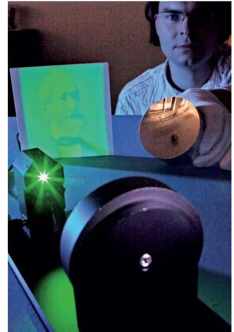
Abb. 3: Freiformoptik für die Strahlformung inkohärenter Quellen (LED).
