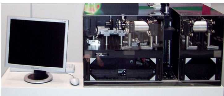
Abb. 2: Portables THz-Bildgebungssystem mit Mehrkanaldetektion.
