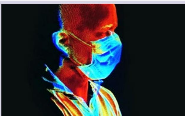
3 *Beispielhafte 3D-Punktwolke mit überlagelter Temperaturtextur. | Exemplary 3D point cloud with superimposed temperature texture.*
