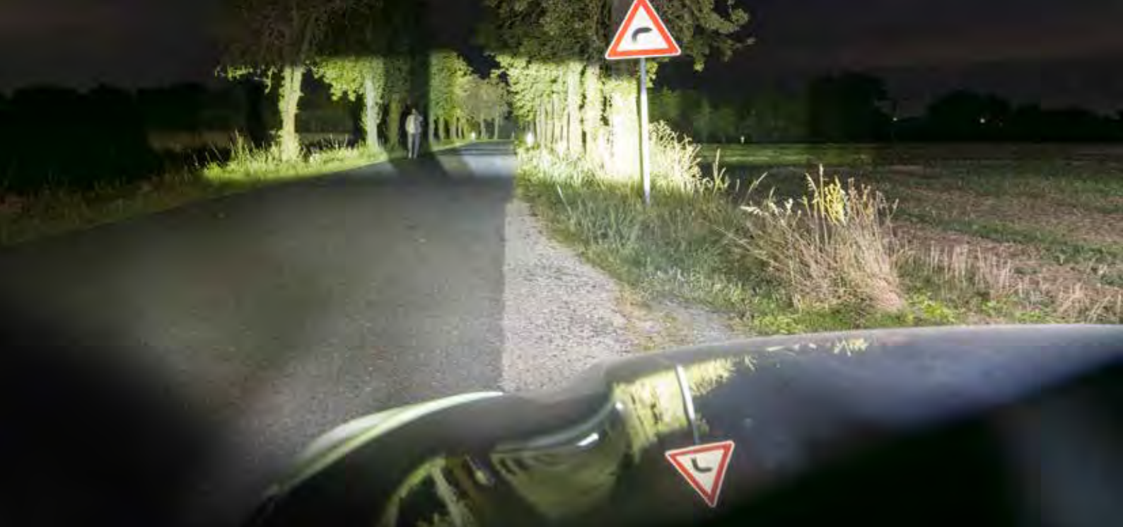
[1] Test der ADB-Funktion zur Vermeidung der Blendung anderer Verkehrsteilnehmer unter realen Bedingungen / Testing the ADB function to prevent blinding other road users under real-life conditions
