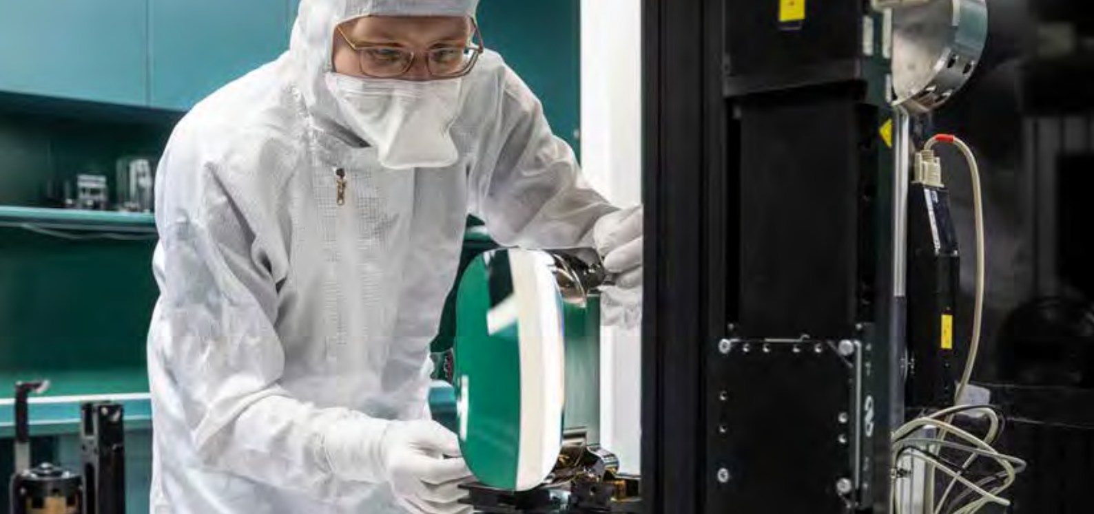
[1] Justage eines Freiformspiegels zur Gewinnung von Streulichtdaten für das Vorhersagemodell der Streulichtperformance des optischen Systems eines Erdbeobachtungssatelliten / Alignment of a free-form mirror to obtain light scattering data for the stray light performance prediction model of the optical system of an Earth observation satellite
