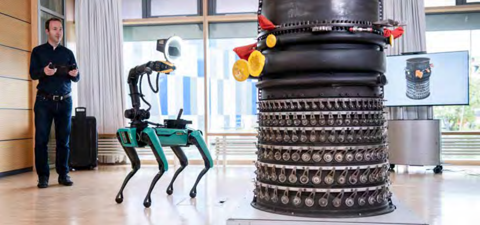
[1] Die Kombination aus Roboterhund und Handscanner macht 3D-Messverfahren noch agiler und flexibler / The unit of a robot dog and the handheld 3D scanner makes the measuring process even more agile and flexible
