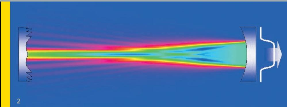
1 *Highbrightness Faserkoppler für Diodenlaserbarren.*
