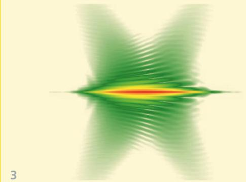
1 *Verzerrung eines 50fs Laserpulses in der Fokumgebung einer Asphäre.*
