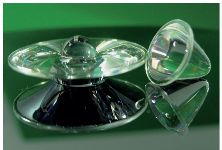
Abb. 2: Diamantgedrehte Prototypen für RXI (links) und TIR-Konzentrator (rechts).
