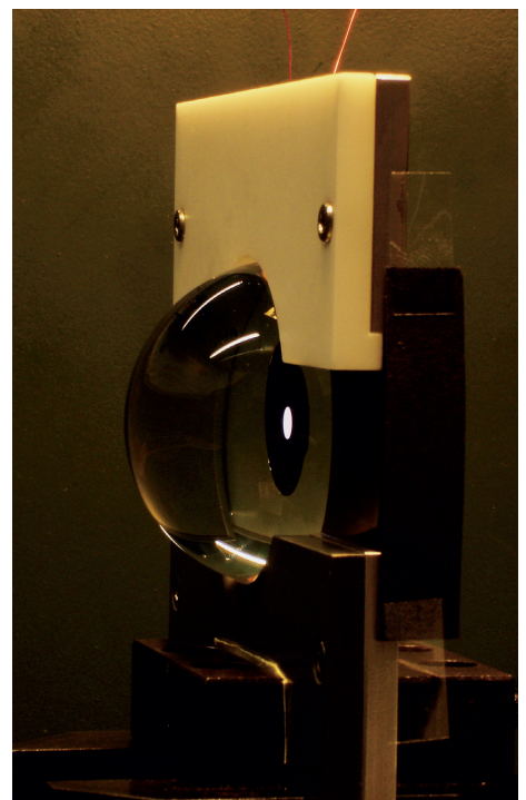
Abb. 2: Beobachtung des Strahlungsfelds einer OLED im Substrat durch eine immersionsgekoppelte Halbkugel.
