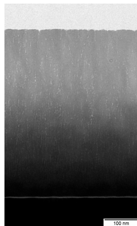
Abb. 2: TEM-Querschnittsaufnahme der in Abb. 1 rechts markierten Tantalpentoxidprobe. Die Porenfraktion ist gut erkennbar, trotzdem ist die Probe shiftfrei.
