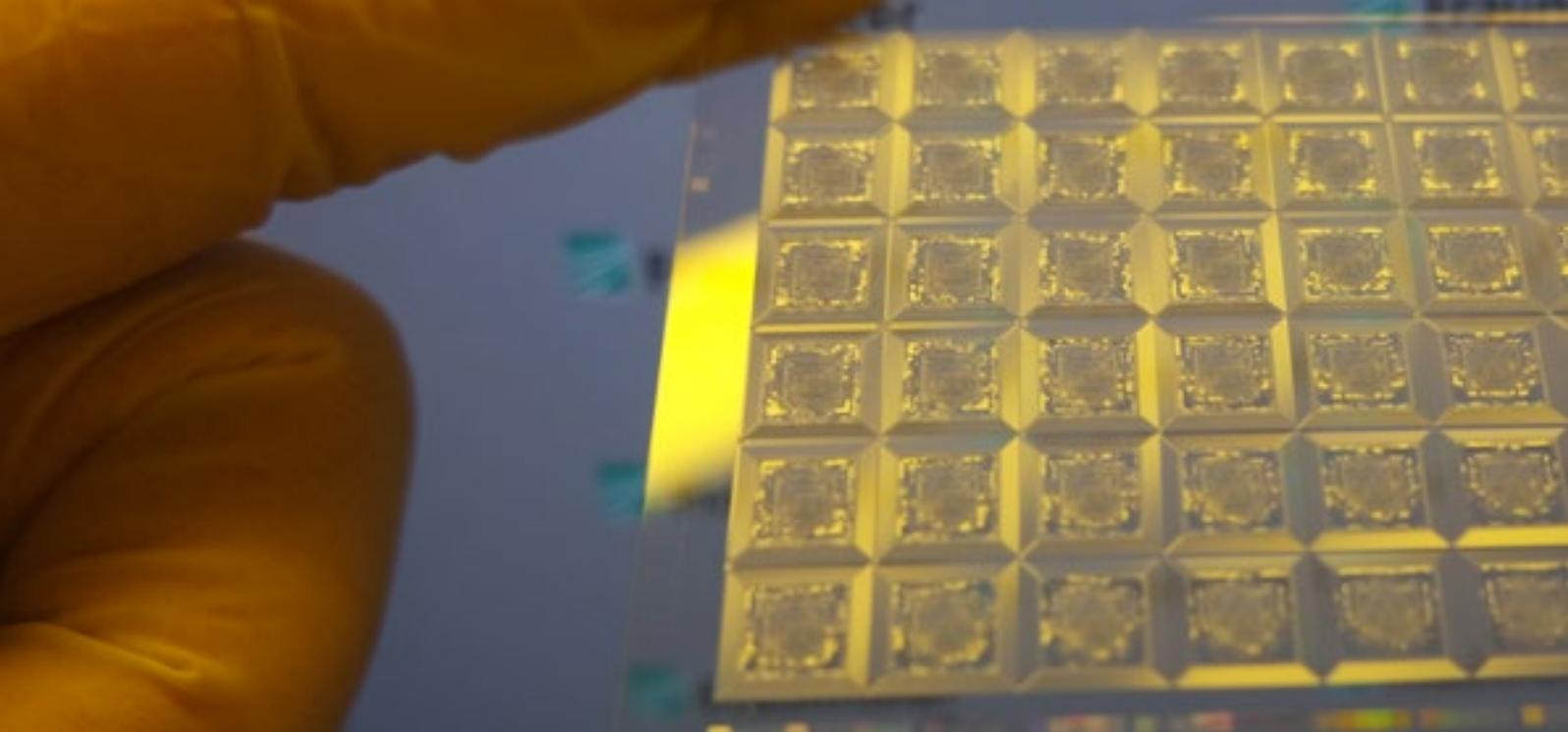
[1] Doppelseitige Strahlformungselemente basierend auf Tailored-Light-Diffusoren zur Homogenisierung einer Display-Direkthinterleuchtung (8 x 6 Kanäle).
